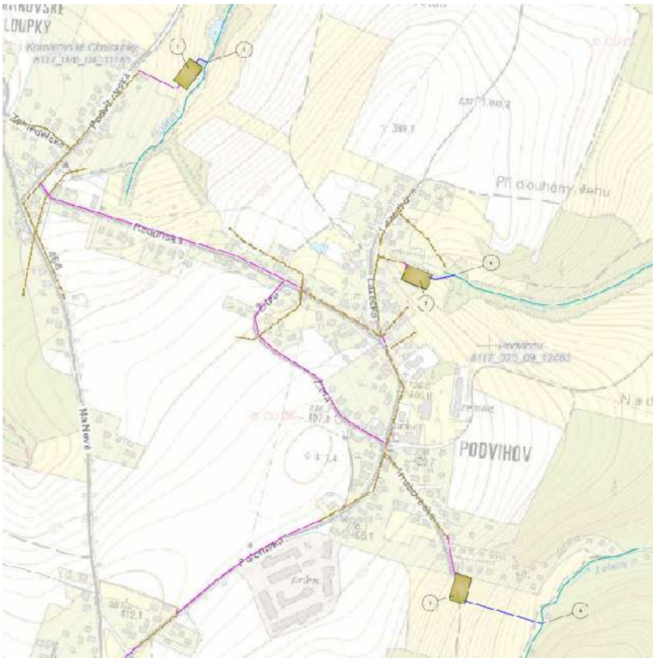
Obr 2: Návrh umístění kořenových čistíren v obci Podvihov
